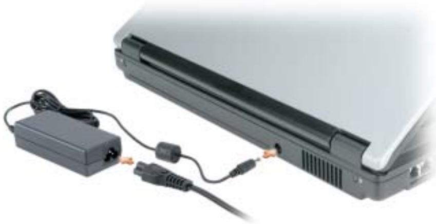
交流适配器将交流电源转换为计算机所需的直流电源。无论计算机处于打开或关闭状态，您均可以连接交流适配器。
