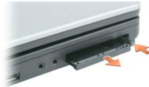
保存好挡片，以备插槽中不安装 ExpressCard 时使用。挡片可以避免未使用的插槽沾染灰尘和其它微粒。
